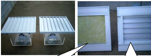
ガルバリウム裏面に断熱材貼り付け グラスウール(25mm/24kg)
